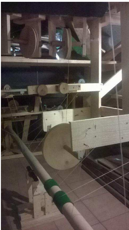
Fig. 13 – Mecanismo de fios e roldanas para os movimentos da Cascata © Liliana Aguiar
