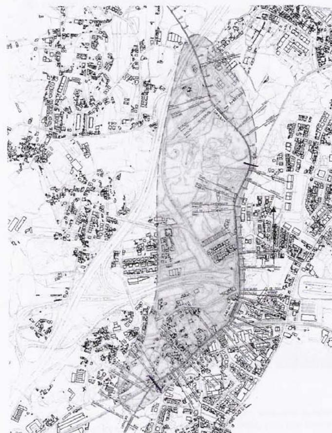
A planta anexa ilustra o traçado da extensão da linha Amarela no troço em que se prevê a ocupação do canal ferroviário já existente, sendo uma parte pertencente à designada Linha de Leixões e a outra à Linha que liga a Ermesinde.
