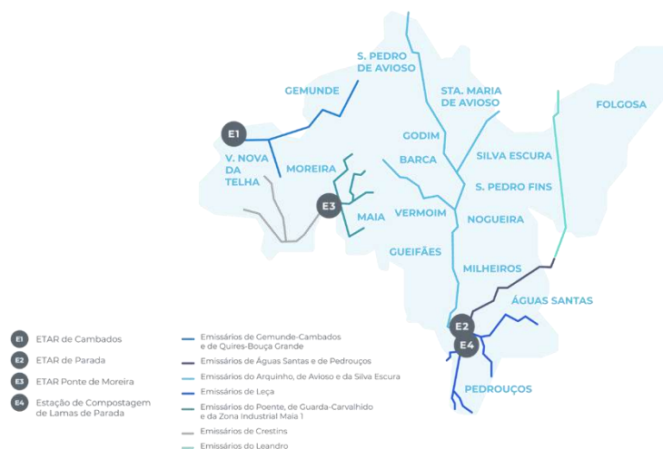
Figura 10. Mapeamento dos sistemas de abastecimento de águas e tratamento de águas residuais no território da Maia (fonte: https://www.smasmaia.pt/ ).
