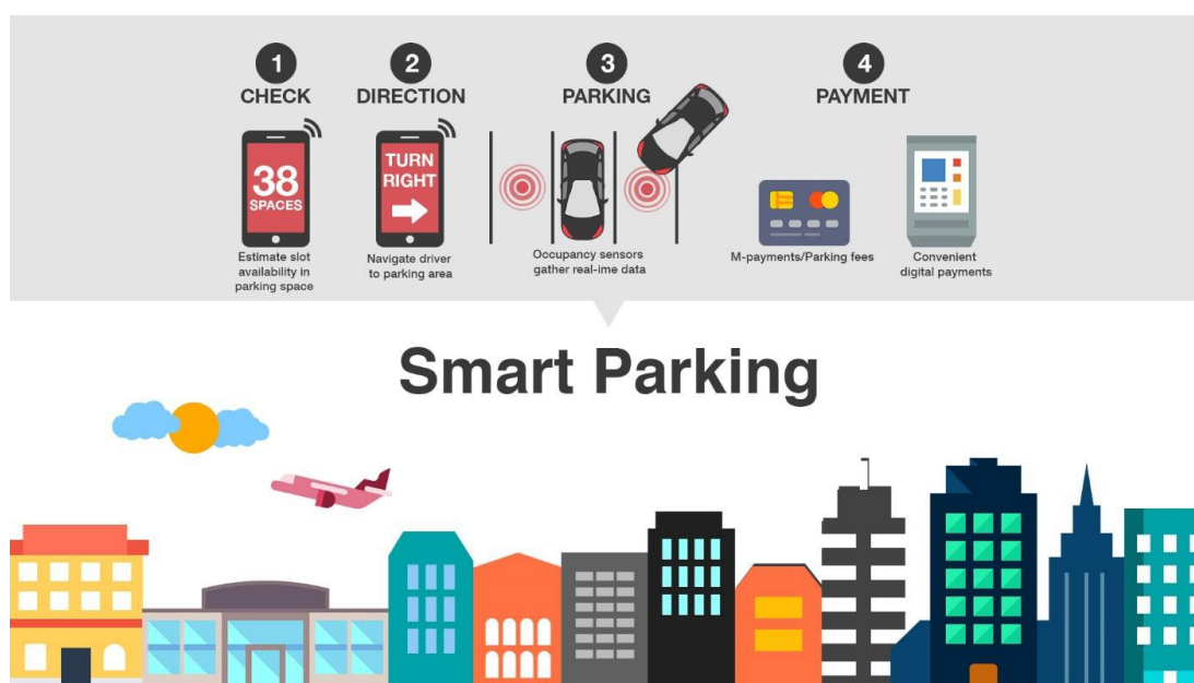
Figura 39. Exemplo do funcionamento do sistema Smart Parking através de sensores
