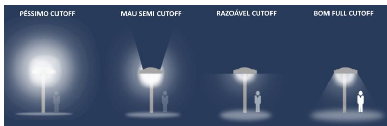
Figura 33 - Tipos de Controlo Rácio de Saída do Fluxo Luminoso Ascendente (ULOR) [12]
